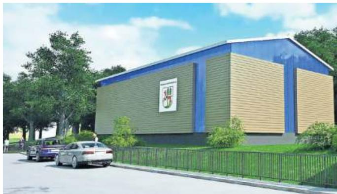
Höhe von 10,25 Metern. Beide Behälter einschließlich der begleitenden technischen Einrichtungen werden in einem Hüllgebäude untergebracht, dessen Dimensionen bei 17 Metern Breite, 31,50 Metern Länge und 9,48 Metern Traufhöhe liegen. Das Satteldach erreicht eine Firsthöhe von ca. 12 Metern.
